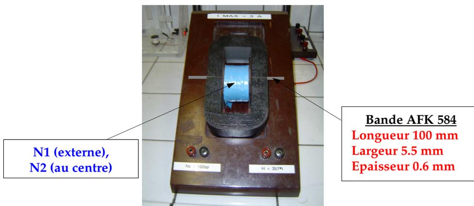
Figure V-26. Perméamètre utilisé pour la caractérisation d'AFK 584.
