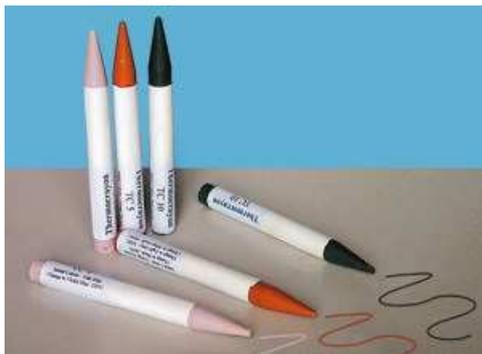
Figure I-4. Crayons thermiques.
