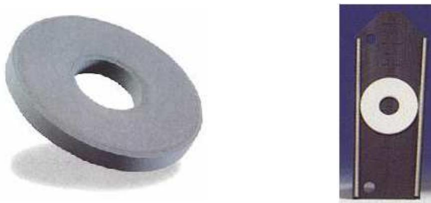
Figure I-3. Anneau Buller et jauge de mesure.
