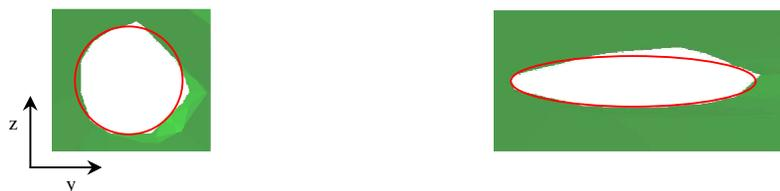
Figure III.80: Evolution de la section d'une mèche avec le cisaillement
