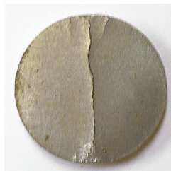
FIG. 2.18 – Rupture d’un échantillon en compression diamétrale.
