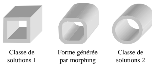
Figure 2-20. Exemple de forme générée par morphing
