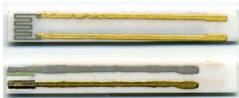
FIG. 1.15 – Image d'un capteur sur support d'alumine plan pour couche sérigraphiée [50].
