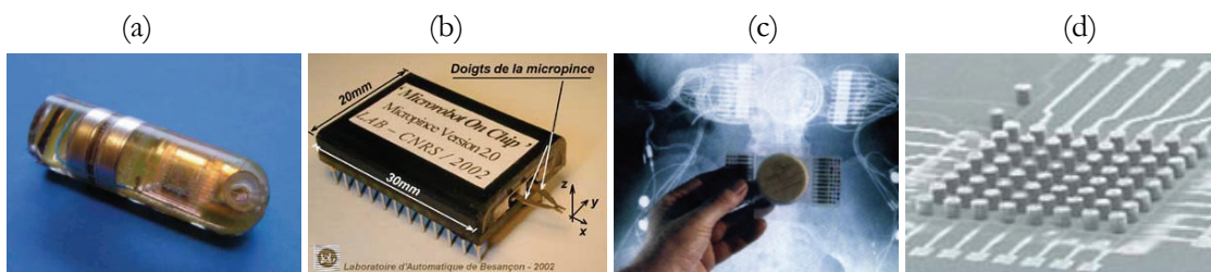
Figure 1.2 Exemples de BIO-MEMS, (a) pilule d'analyse intelligente, (b) micro-pince, (c) puce électronique implantée pour la stimulation des muscles, (d) puces à ADN.
