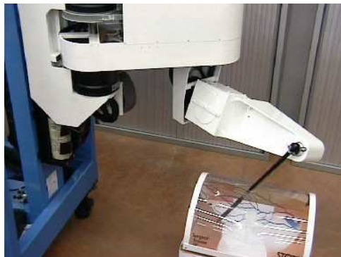
Figure 4.5 - Plate-forme expérimentale et simulateur pour le passage par un point fixe.
