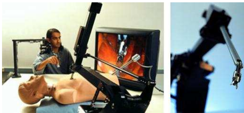
Figure 1.6 - La plate-forme The Black Falcon dédiée à la chirurgie mini-invasive télé-opérée [Madhani, 1998].
