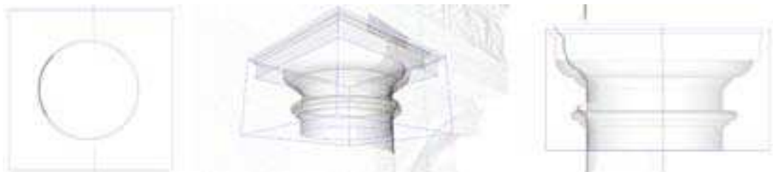
Figure 53. Première étape d'instanciation de la primitive. De gauche à droite : le plan d'intersection horizontal, la primitive dans le nuage de points, le plan d'intersection vertical.
