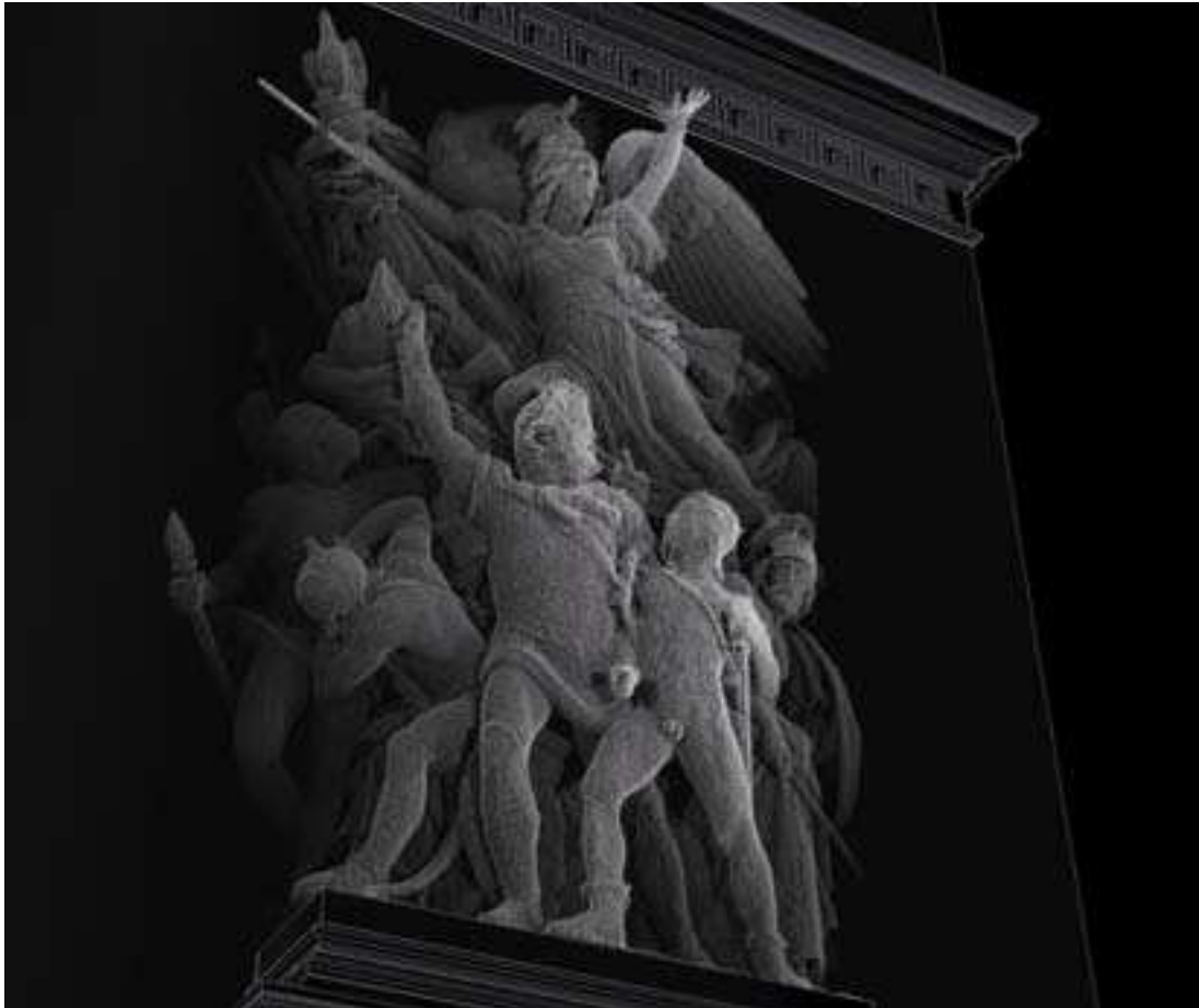
Figure 74. Carte de profondeur calculée sur le nuage de points d'un groupe ( La marseillaise ) ornant l'arc de triomphe, place de l'Etoile à Paris.
