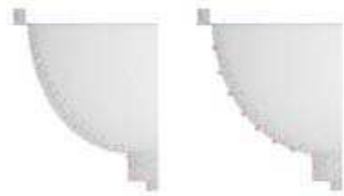
Figure 55. Troisième étape d'instanciation de la primitive: les points de contrôle des courbes.
