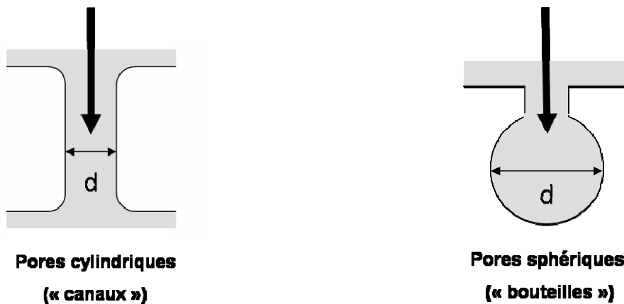
Figure B. 4 : Schématisation de pores cylindriques et sphériques
