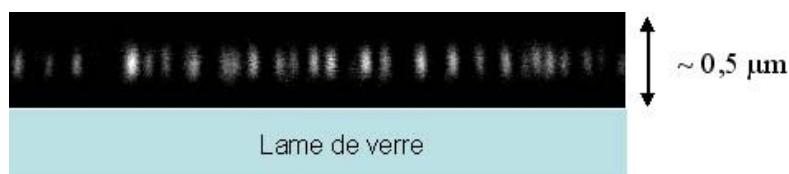
Figure V. 2 : Coupe en z obtenue par microscopie confocale d'une couche sol-gel contenant des nanocristaux de rubrène de 200 nm environ
