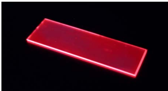
Figure I. 25 : Photo sous excitation UV d'une couche mince sol-gel déposée sur verre contenant des nanocristaux moléculaires luminescents
