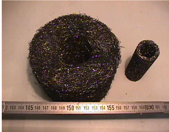
Figure n°51 : modèle de matrice utilisée initialement (diamètre 100 mm) et modèle actuel (30 mm). La compréhension des mécanismes de capture et des phénomènes électriques dans l'espace inter-électrodes a permis de gagner un facteur 10 sur le volume, tout en augmentant l'efficacité de filtration.
