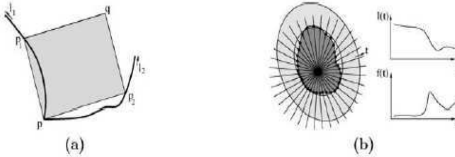
FIG. 2.4 – Principes des détecteurs EBR et IBR. a) EBR exploite les contours de l’image ; b) IBR exploite l’information photométrique. Image reproduite d’après l’article de Tuytelaars et Van Gool [153].
