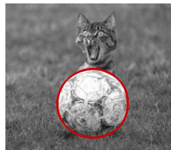
(d) \lambda = 10000 . Une forte régularisation implique une conservation de la forme de départ, même dans la partie du ballon occultée par l'herbe. Segmentation achevée en 60 itérations, 2.5s.
