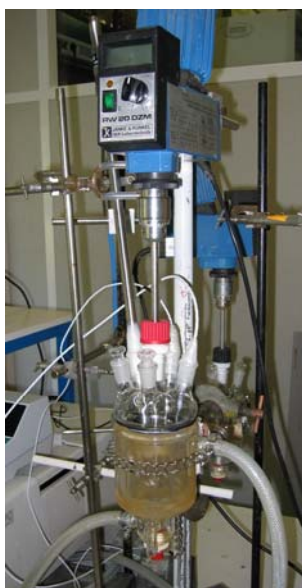
Figure C - 8, Réacteur de cristallisation de 200 ml à double enveloppe régulée en température par un bain thermostaté.
