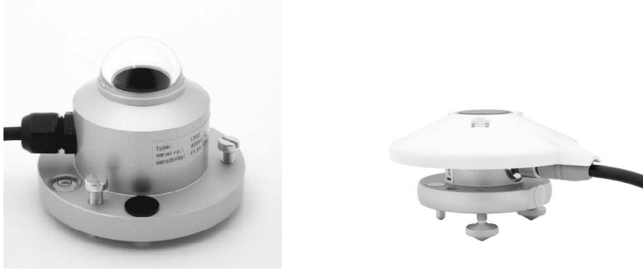
FIG. 2.3: Photos d'un pyranomètre (gauche) et d'un pyr géomètre (droite).
