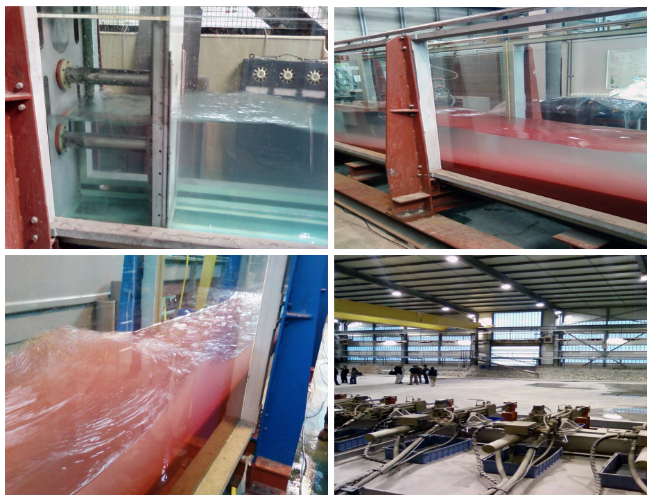
FIG. 6.1 – En haut à gauche : La partie offshore du canal à houle du LEGI - Le battant sert à générer la houle au large ; En haut à droite : Vue de côté du canal à houle du LEGI - Le sable (en rouge) est transporté par la houle. En bas à gauche : Déferlement de la houle à l'approche du rivage ; En bas à droite : Le bassin à houle de la SOGREAH (30m x 30m) où la plage de Sète sera reproduite en échelle réduite.
