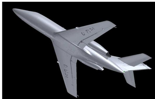
d -Modèle calculé sur les mesures de photogrammétrie
