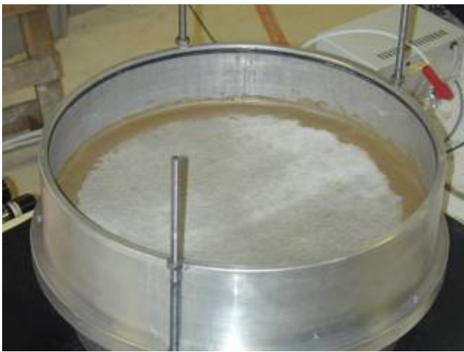
(i) étanchéité latérale avec la bentonite
