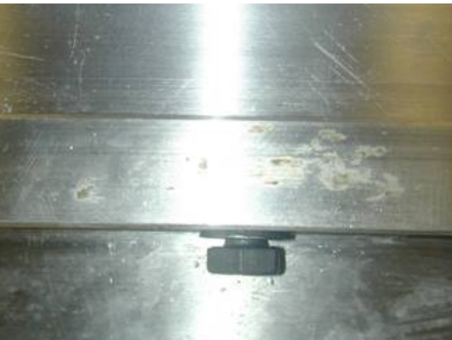
(e) parafuso fixador das unidades inferior e intermediária
