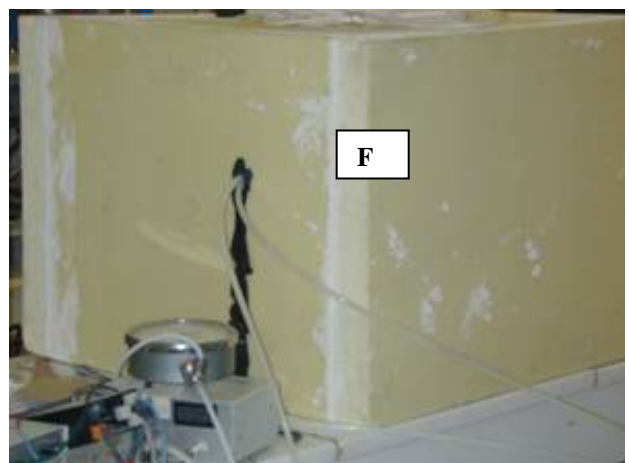
(d) isolation thermique ( F )
