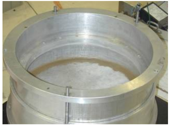
(m) mise en place de la cellule supérieure (vue de dessus)
