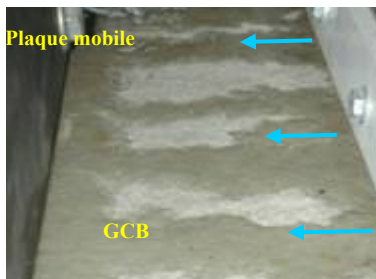
(c) interface Géomembrane PEHDc-GCB BF soumise à dessiccation et au ruissellement d'eau
