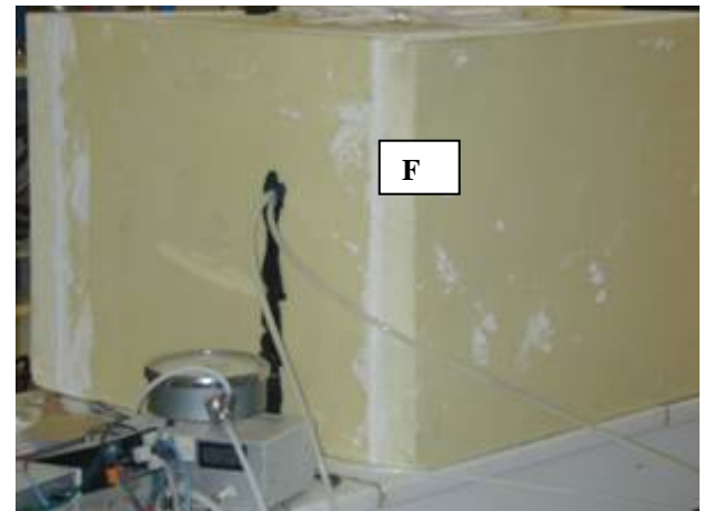
(d) caixa de isolamento térmico ( F )
