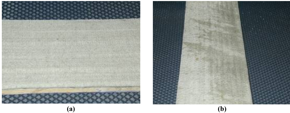
Figure 7.23. Détails de la surface du géotextile tissé après les essais d'interface avec le géonet: (a) essai sur surface sèche du géonet; (b) essai sur surface humide du géonet.
