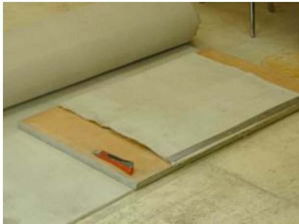
(a) amostra de ensaio cortada do rolo de GCL
