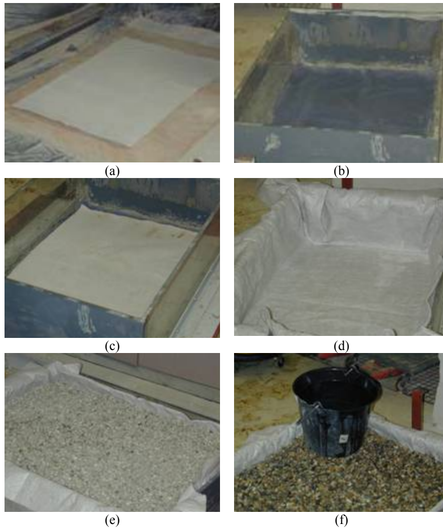
Figura 7.4. Hidratação sob confinamento de amostras de GCL destinadas aos ensaios de interface com geomembranas: (a) amostra de GCL cortada; (b) tanque de confinamento com manta geotêxtil no fundo; (c) colocação da amostra de GCL no interior do tanque; (d) geotêxtil de proteção superposto à amostra de GCL; (e) confinamento realizado por brita graduada; (f) inserção de água de hidratação do GCL.
