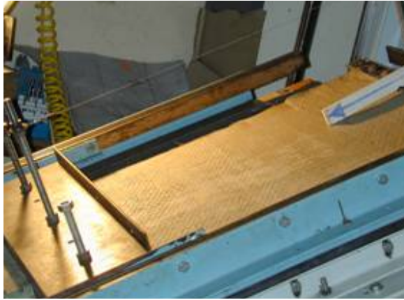
(a) interface Geomembrana PEADc-GCL BF hidratado
