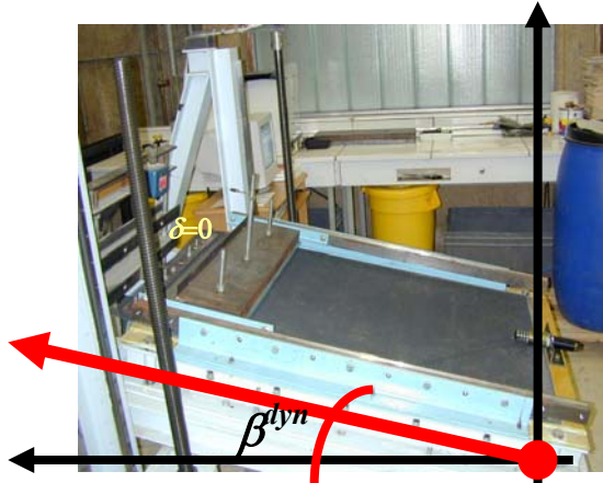
(b) début de l'essai ( \delta=0 ) avec \beta^{dyn} > \beta_s préalablement fixé
