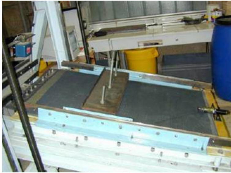
(a) équipement d'essai « plan incliné » pour les interfaces géosynthétique-géosynthétique
