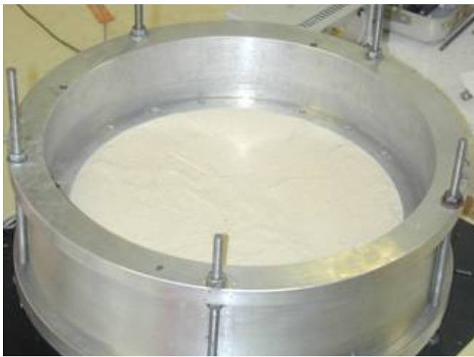
(p) couche de sable au-dessus du GCB
