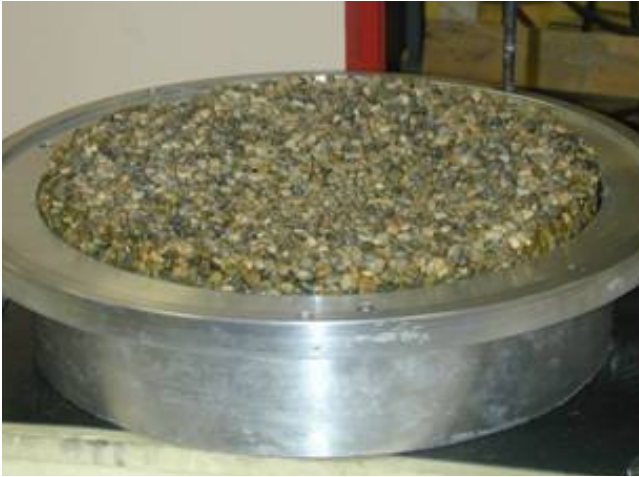
(a) cellule inférieure et pierre poreuse
