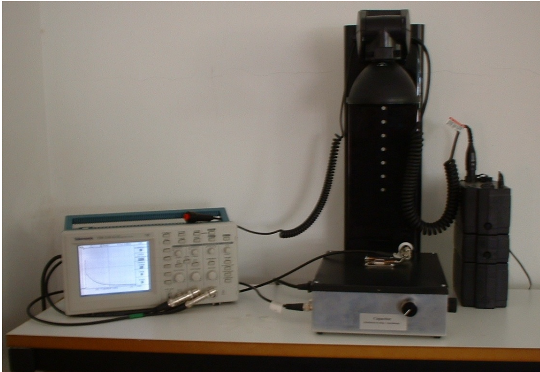
Figure 4.10 – Vue de l'appareil de photoconductivité Sinton WCT-100
