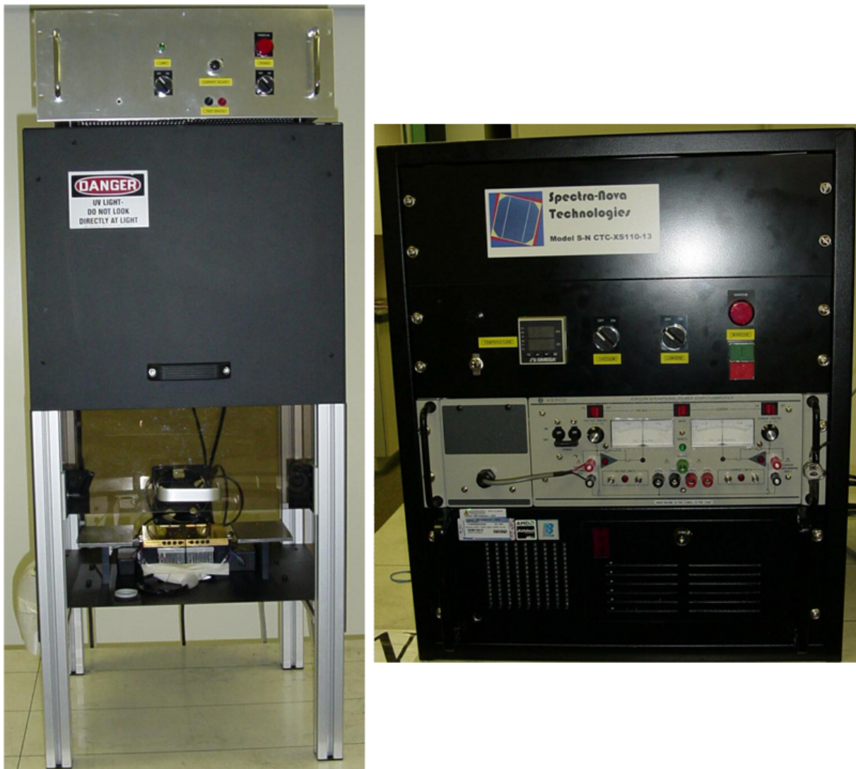
Figure 2.23 – Photographies du simulateur solaire du laboratoire (rack électrique à droite)
