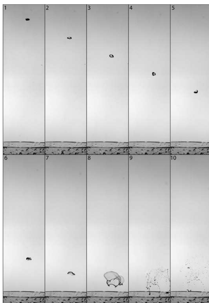
FIG. 3.3 – Déformation et atomisation d'une goutte liquide dans un jet d'air ascendant. Le temps va de gauche à droite et de haut en bas. Le temps entre chaque image est de 1/100 s. La sortie du tube est visible au bas de chaque image.
