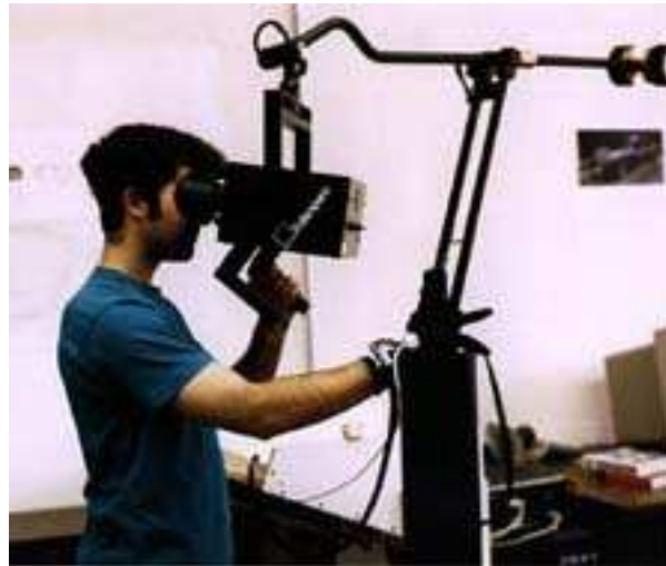
Photo 4 : système d'écrans BOOMS de Fake Space Labs. Le boîtier, qui comporte deux écrans à tubescathodiques est placé à l'extrémité d'un bras articulé.
