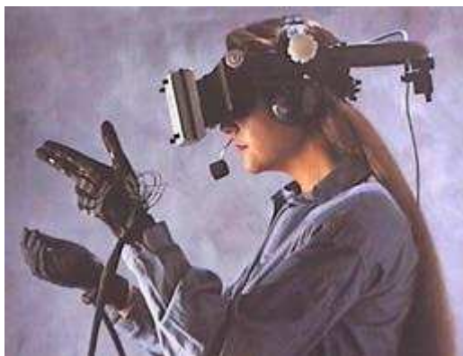
Photo 22 : Premier visiocasque ou HMD portatif élaboré par la NASA. (Image NASA).
