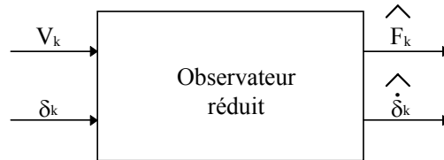
Fig. 4. 16 : Structure de l'observateur réduit pour l'estimation de la force et de la vitesse
