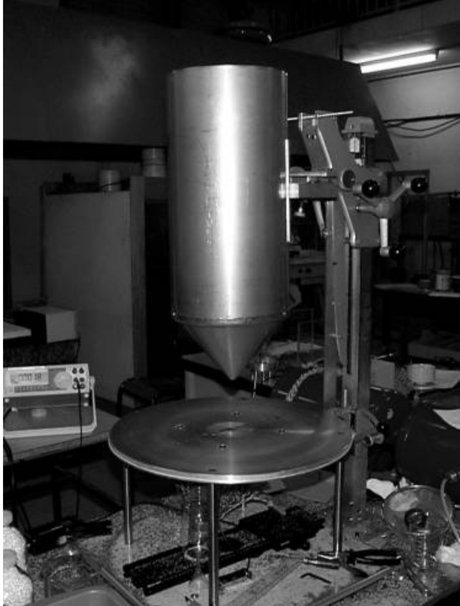
FIG. 3.6: Le montage permettant de réaliser un tas conique par avalanches comprend : un plateau de 52cm de diamètre à la surface duquel on peut faire affleurer un capteur de pression ; un réservoir à embouchure conique (diamètre 11.7mm) monté sur une crémaillère.
