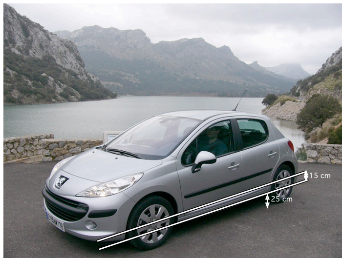
FIGURE 4.6 – Hauteur d'eau nécessaire pour faire flotter et emporter une voiture classique.
