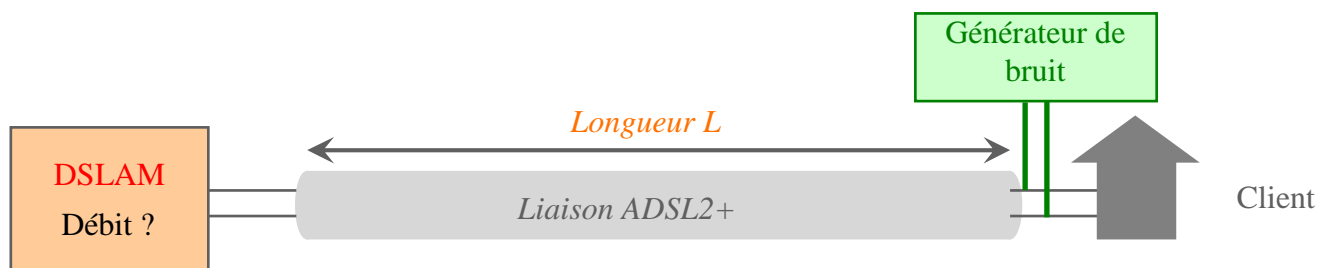
Figure III.19 - Gain en débit sur une liaison ADSL2+
