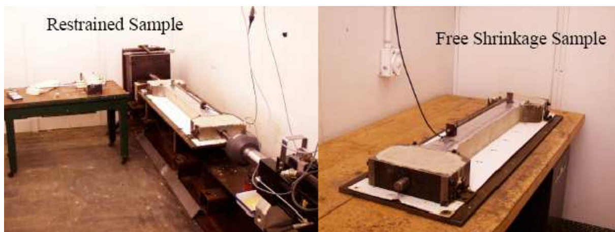
FIG. 2.1: Vue générale d'un dispositif de retrait empêché linéique, avec à droite : l'échantillon pour la mesure de retrait libre et à gauche : l'échantillon dont le retrait est bloqué, tiré de (Altoubat et Lange 2003 [65])
