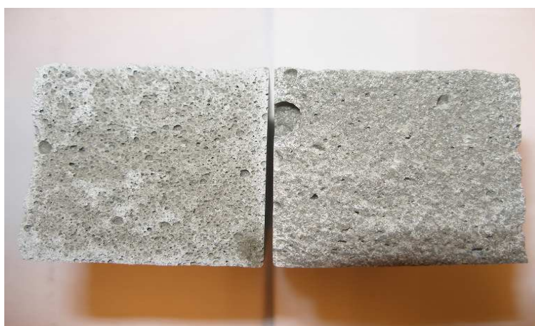
FIG. 1.15: À gauche : mortier (E/C = 0,8) avec ajout d'un éther de cellulose de type MHPC à 0,1 % de la masse totale sèche, à droite : le même mortier sans ajout d'éther de cellulose
