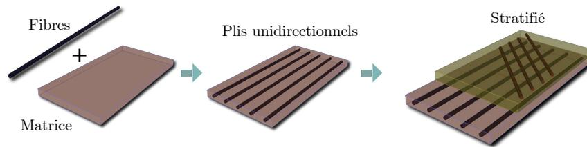
Figure 1.1: Composition d'un composite stratifié
