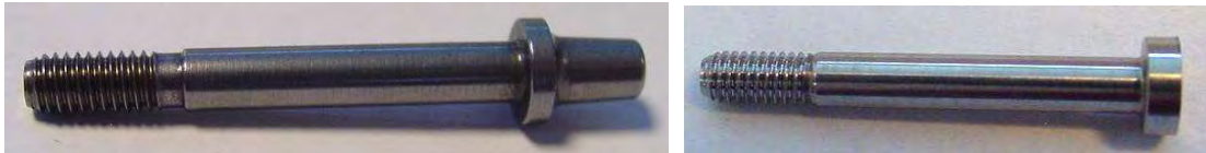
Figure 19 : Doigt de malaxage. a) doigt normal, b) doigt plat ou bouchon
