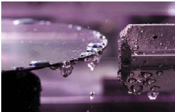
Fig. I.13 : Utilisation d'un jet d'eau pour séparer les 2 wafers [17].
