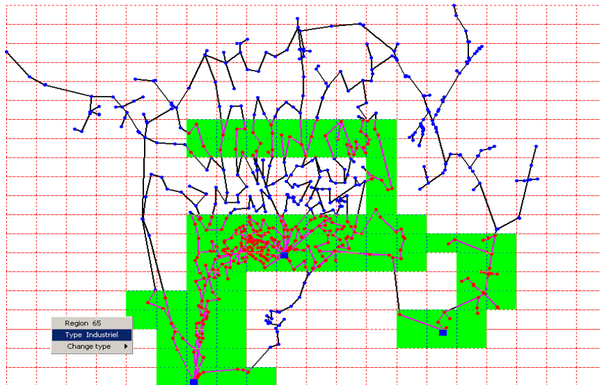
Figure V-11 : Découpage de la carte du réseau EDF en zones de consommation de type industriel (en vert) et résidentiel (en blanc) – capture d'écran
