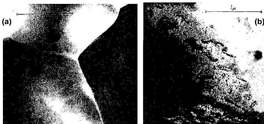
Figure I-5 : Observation MET de lames minces de dioxyde d'uranium implanté en xénon à 8 \times 10^{10} \text{at.cm}^{-2} (a) et à 2 \times 10^{16} \text{at.cm}^{-2} (b) puis recuit à 1200°C [Matzke 1966].
