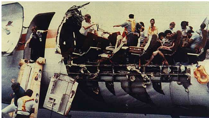
Figure 5. A l'origine de l'accident spectaculaire du Boeing 737 d'Aloha Airlines en 1988 ([VOGE(2000)]), des fissures de fatigue dans le fuselage
