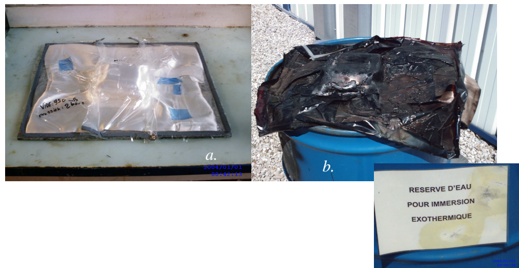
Figures 109. Conséquence du confinement de la chaleur exothermique lors de la tentative de cuisson d'un empilement épais de Redux 222 supporté. a. aspect initial du drapage b. drapage auto-carbonisé
