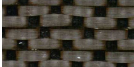
Figure 38. Architecture d'un pli de tissu satin 4H carbone-époxy après cuisson en autoclave
