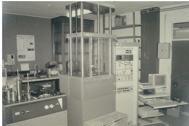
Figure 93. Machine hydraulique de traction haute vitesse utilisée pour la fatigue des anneaux tressés en compression latérale
