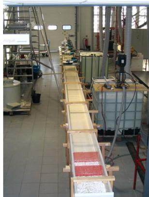
Figure 2.11 : photographie de la maquette de cours d'eau.
