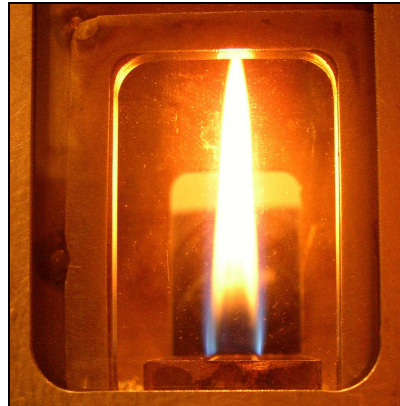
Figure 22 : Brûleur Wolfhard-Parker pour l'étude de la flamme de diffusion 1D
