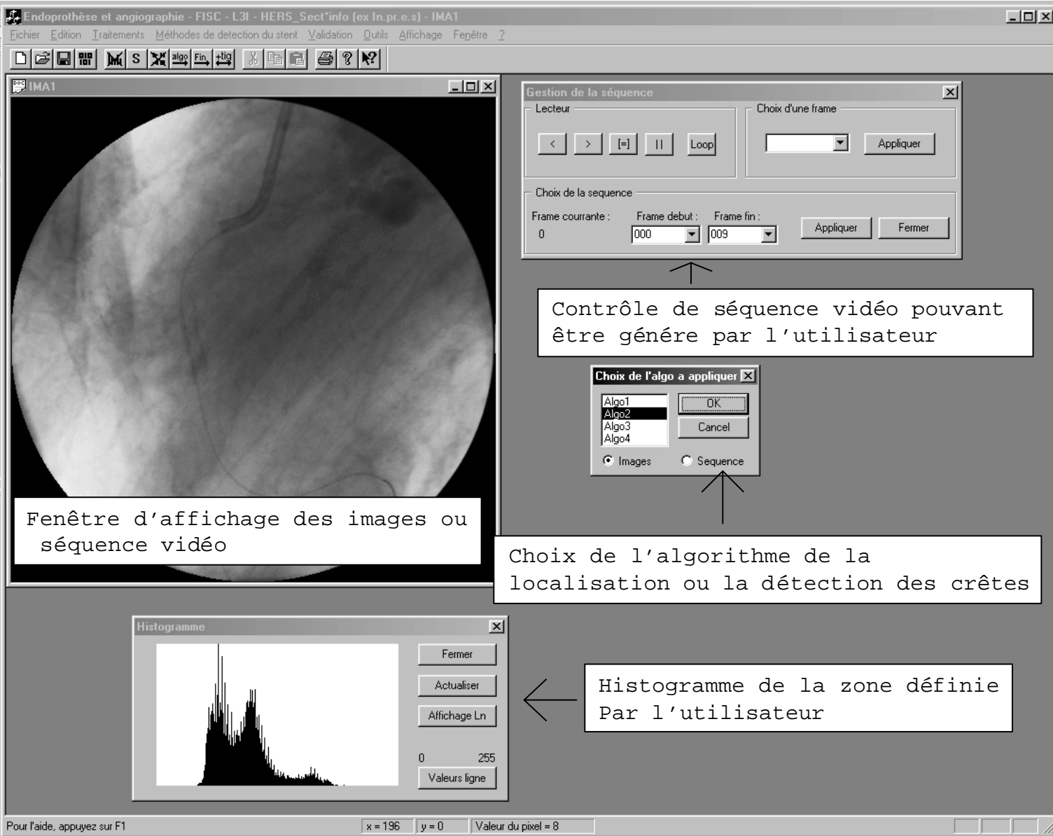
FIG. C.2 – Capture d'écran de l'interface générale du logiciel.
