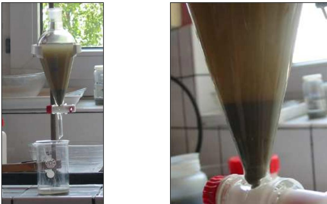
**Figure 2.19.** Photographies montrant le principe de décantation par ampoule à décanter. L'image de droite agrandie permet de voir nettement la limite entre deux classes granulométriques.
