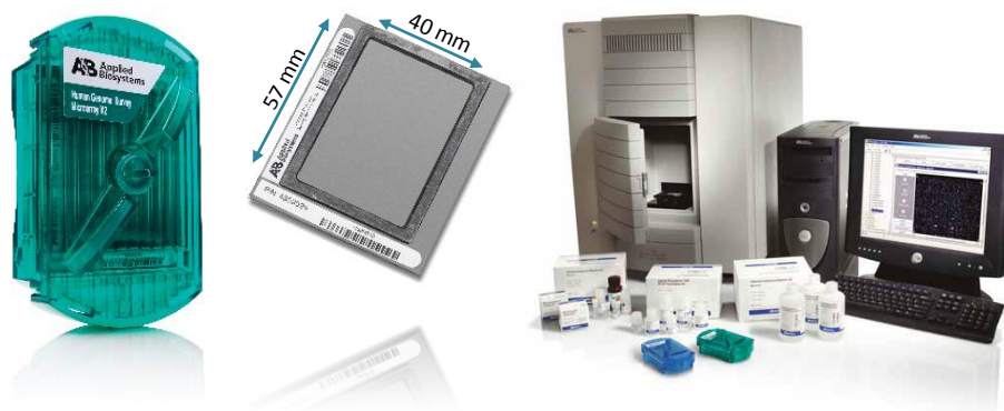
Figure 1.19 – Photographie d'une plateforme de puces à ADN d'Applied Biosystems (AB). A gauche une puce, ses dimensions sont plus grandes qu'une lame de verre : Le diamètre de la membrane (au centre) est voisin de 7 cm. A droite, la photo montre le scanner.
