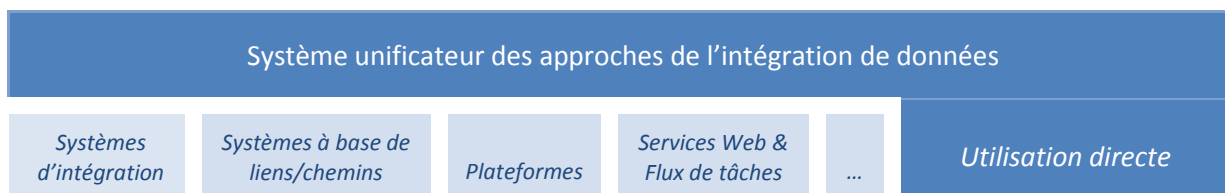
Figure 3.8 – Notre approche (blanc sur bleu foncé) se positionne comme une couche unificatrice favorisant l'interopérabilité des approches existantes. Elle propose un ensemble de services et d'outils fonctionnels permettant le développement rapide d'applications métiers accédant aux données intégrées et les visualisant.
