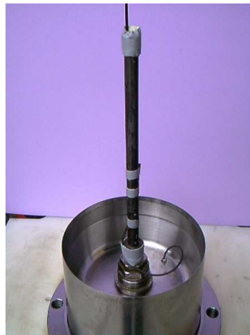
FIG. 2.13 – Système de détection d'allumage par fibre optique
