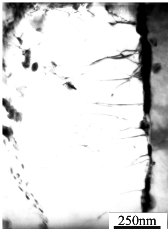
FIG. 2.47 : Observations au MET de dislocations interagissant avec un joint de latte après un essai CF \Delta\epsilon_t = 0.4\% , \epsilon_{creep} = 0.1\% .
