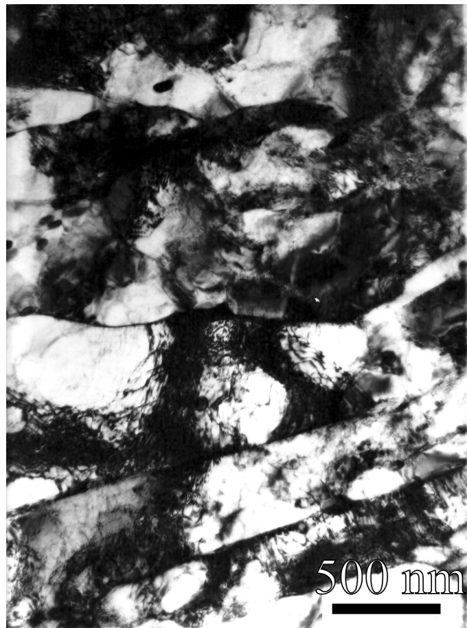
FIG. 1.22 : Observation au MET du P91 illustrant l'hétérogénéité spatiale des densités de dislocations.
