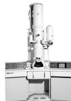
Figure II-12 : Aperçu d'un MET avec sa colonne sous vide abritant le filament et les lentilles pour générer et focaliser le faisceau électronique sur l'échantillon.
