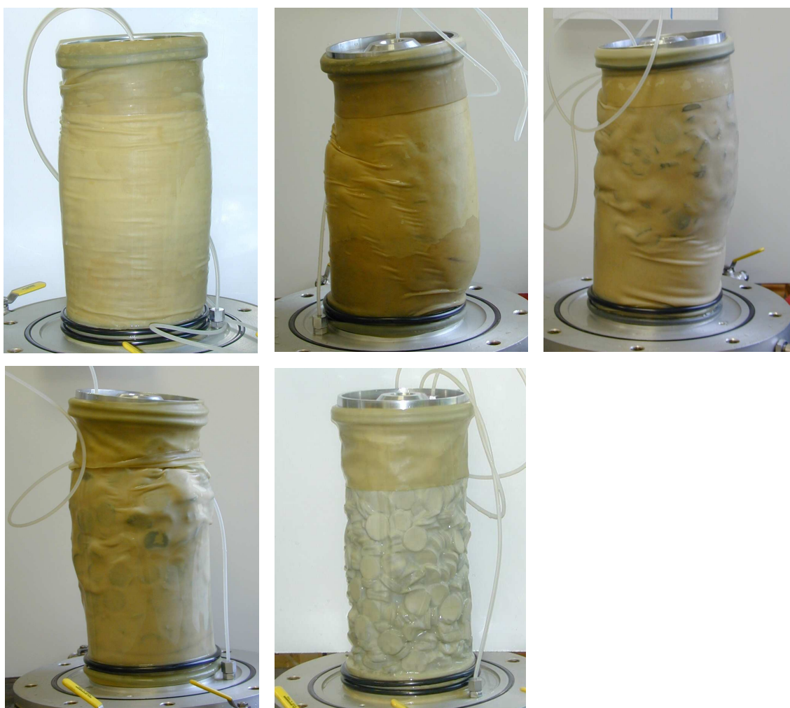
Figure 5.7 : Photographies des échantillons en fin d'essais. De gauche à droite et de haut en bas : P_v = 0\% , 11\% , 31\% , 43\% et 58\% .
