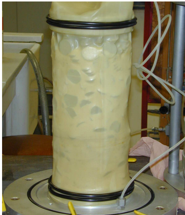
Figure 5.3 : Ecoulement du sable vers le fond de l'échantillon pour P_v = 43\% .
