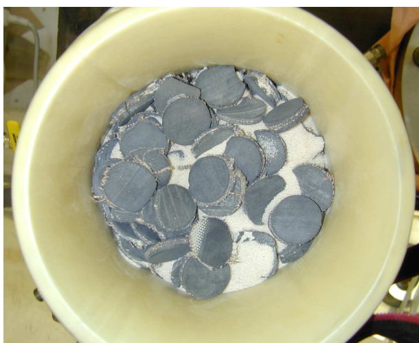
Figure 5.2 : Photographie des pastilles de pneus et du sable lors de la réalisation d'un échantillon.
