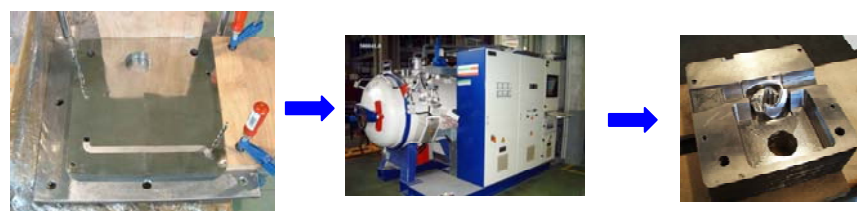
Figure 12 : Brasage fort pour outillage fonderie injection aluminium – Projet CRAFT MOLSTRA (Thabourey, 2006)
