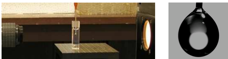
FIG. 1.12 – Technique de la goutte pendante. Sur la vue de gauche (OCA15 Dataphysics), apparaît à gauche l'objectif de la caméra utilisée pour acquérir le profil de la goutte pendante illuminée par une source visible sur la droite. La vue de droite est l'image de la goutte fournie par la caméra et utilisée pour l'identification de la tension de surface.
