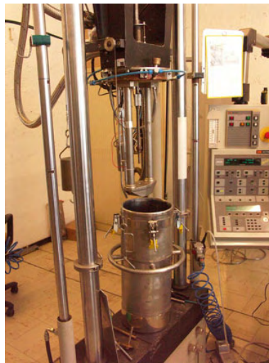
FIG. 8.3 – Dispositif expérimental complet de Air Liquide avec la machine de traction, le cryostat et la console.
