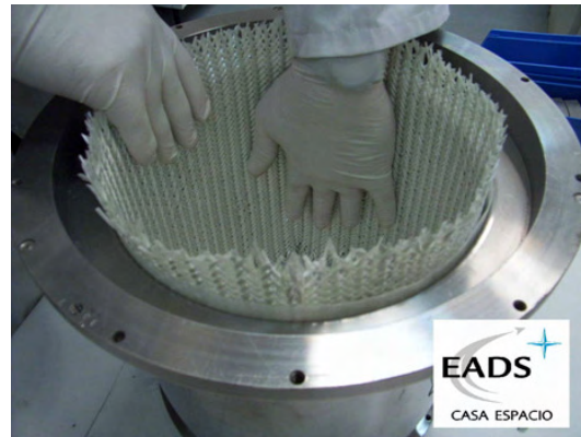
FIG. 1.5 – Mise en place du renfort dans le moule [61].
