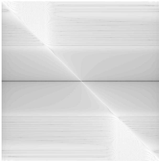
Figure 4.10 – Exemple de matrice de transfert inverse dans le domaine de l'interférogramme. L'amplitude des coefficients est représentée sur une échelle logarithmique d'intensité (ILS d'un détecteur circulaire centré, R/f = 0.2 , 513 points, intégration sur 64 échantillons de l'ILS).
