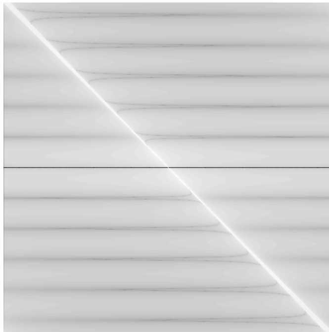
Figure 4.3 – Exemple de matrice de transfert dans le domaine de l'interférogramme. L'amplitude des coefficients est représentée sur une échelle logarithmique d'intensité (ILS d'un détecteur circulaire centré, R/f = 0.3 , 513 points, intégration sur 64 échantillons de l'ILS).
