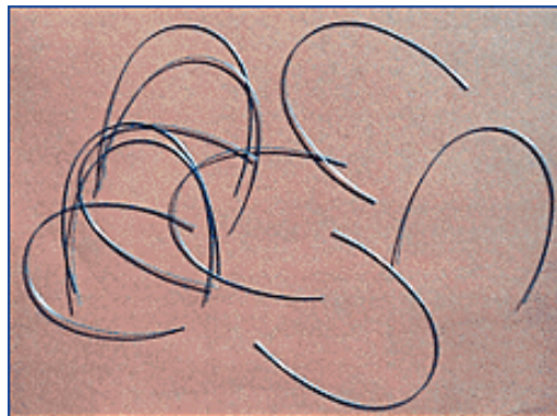
FIG. 1: Exemple d'utilisation des AMF : fil utilisé en orthodontie. (source : http://www.amtbe.com/ )
