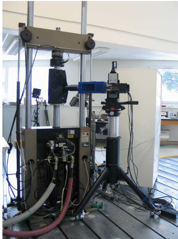
FIG. 3.36 : Trépied et montage de la caméra infrarouge.
