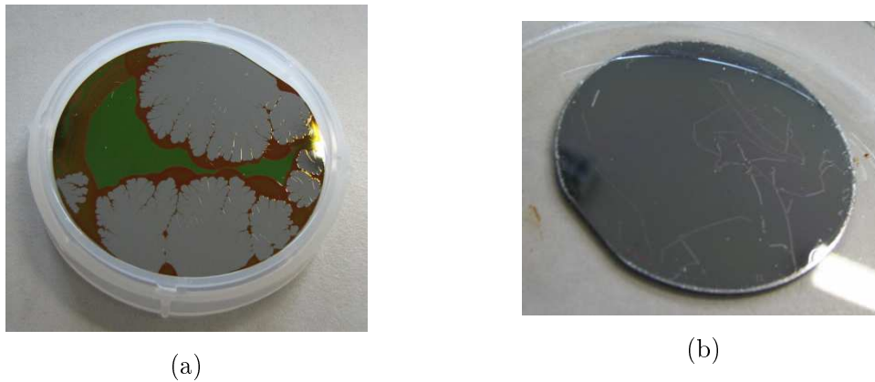
FIG. F.1 – (a) Photographie d'un substrat de 2 pouces de silicium sur laquelle une couche de PMMA-DCM n'a pas tenu. (b) Photographie d'un substrat de 2 pouces de silicium recouvert par trois couches de SOG.
