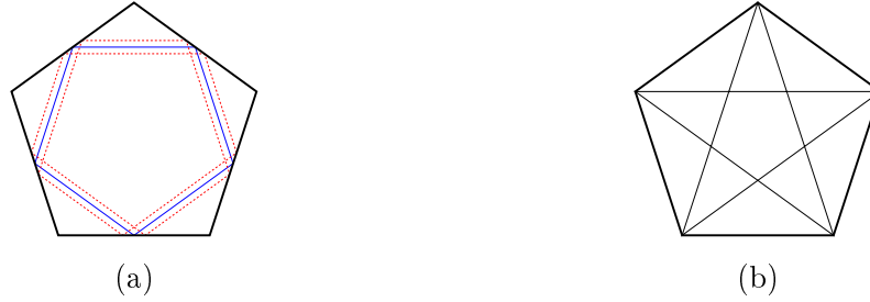
FIG. 4.21 – Orbites les plus simples confinées par réflexion totale. (a) La ligne continue bleue correspond au pentagone inscrit qui est une orbite isolée. L’orbite périodique dans son voisinage est tracée en pointillés rouges. Elle se présente sous la forme d’un double pentagone et appartient à la famille de l’étoile à cinq branches. (b) Orbite périodique en forme d’étoile à cinq branches. Elle correspond à la frontière du canal représenté par des hachures sur la figure 4.15
