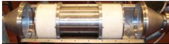
Figure 10 : Réacteur déNOx prototype dans sa coque
