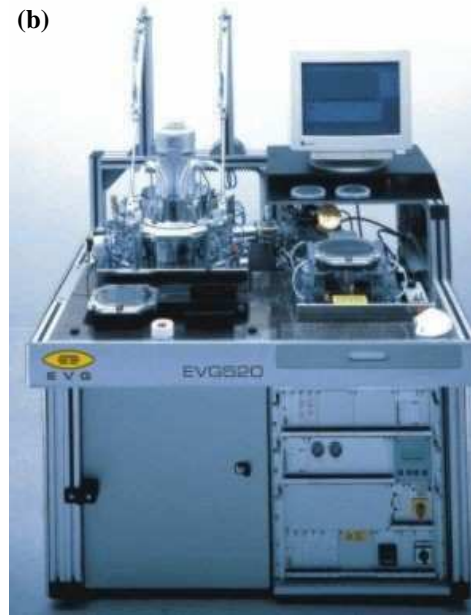
Fig.7 : Les presses dédiées à la lithographie par nanoimpression au LTM. (a) Presse Digipress. (b) Presse EVG520.
